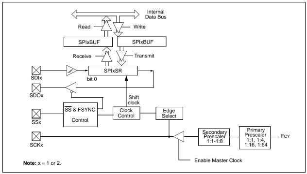
FIGURE 15-2: SPI MASTER/SLAVE CONNECTION
